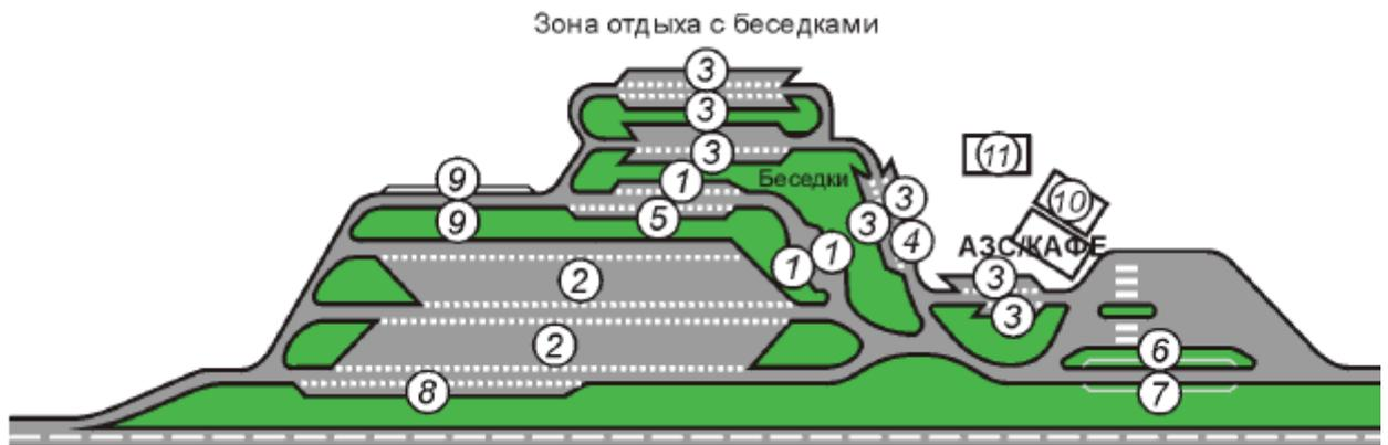
1-8 - места для парковки транспортных средств (1 - автобусы; 2 - грузовые автомобили/автобусы; 3 - легковые автомобили/мотоциклы; 4 - места для лиц с ограниченными возможностями; 5 - легковые автомобили с прицепами (продольная парковка); 6 - легковые автомобили (продольная парковка); 7 - грузовые автомобили (продольная парковка); 8 - крупногабаритный/тяжеловесный транспорт (продольная парковка); 9 - площади для потенциального расширения; 10 - туалет; 11 - мусоросборник
