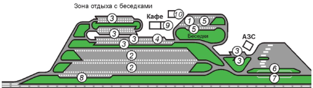
1-8 - места для парковки транспортных средств (1 - автобусы, 2 - грузовые автомобили, 3 - легковые автомобили/мотоциклы, 4 - места для лиц с ограниченными возможностями, 5 - легковые автомобили с прицепами (продольная/косая парковка), 6 - легковые автомобили (продольная парковка), 7 - грузовые автомобили (продольная парковка), 8 - крупногабаритный/тяжеловесный транспорт (продольная парковка); 9 - туалет; 10 - мусоросборник
