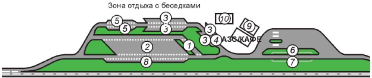
1-8 - места для парковки транспортных средств (1 - автобусы; 2 - грузовые автомобили/автобусы; 3 - легковые автомобили/мотоциклы; 4 - парковочные места для лиц с ограниченными возможностями; 5 - легковые автомобили с прицепами (продольная парковка); 6 - легковые автомобили (продольная парковка); 7 - грузовые автомобили (продольная парковка); 8 - крупногабаритный/тяжеловесный транспорт (продольная парковка); 9 - туалет; 10 - мусоросборник
